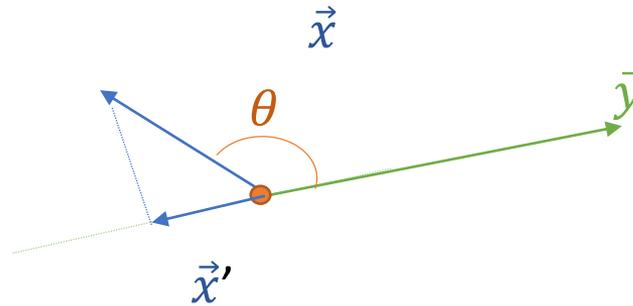
Si  $\vec{x}'$  est la projection orthogonale de  $\vec{x}$  sur  $\vec{y}$ , alors
