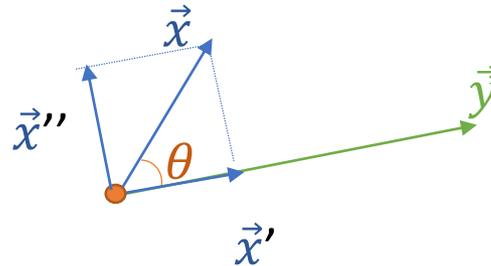
$\vec{x}'$  est la **projection orthogonale** de  $\vec{x}$  sur  $\vec{y}$ , et  $\vec{x}''$  est la composante perpendiculaire de  $\vec{x}$ . Alors on a les relations suivantes
